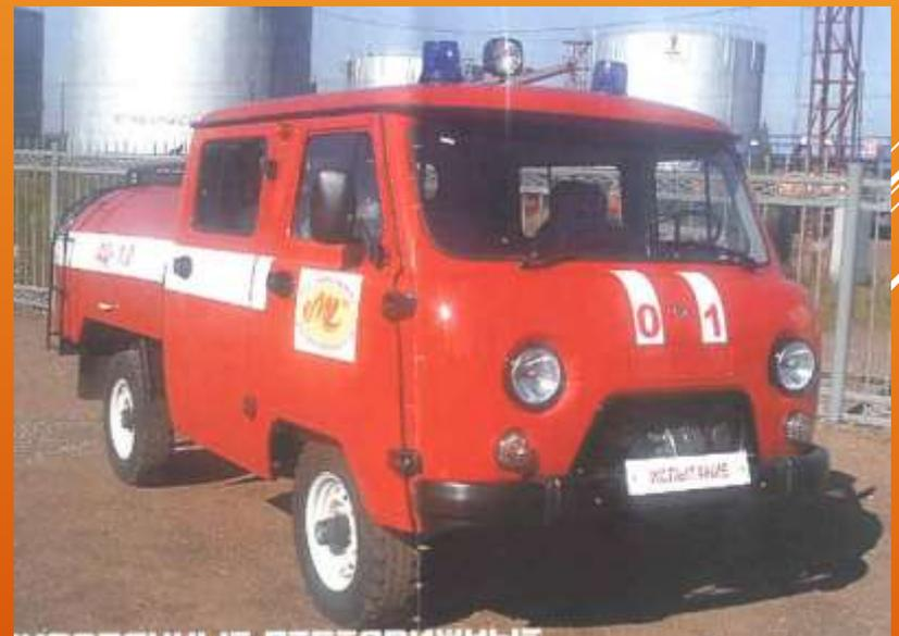
2. АВТОЦИСТЕРНЫ ПОЖАРНЫЕ ПРЕДНАЗНАЧЕНЫ ДЛЯ ДОСТАВКИ К МЕСТУ ПОЖАРА БОЕВОГО РАСЧЁТА, ЗАПАСА ОГНЕТУШАЩИХ ВЕЩЕСТВ, ПОЖАРНО-ТЕХНИЧЕСКОГО ВООРУЖЕНИЯ, ПОДАЧИ ВОДЫ (ИЗ ЦИСТЕРНЫ, ОТКРЫТОГО ВОДОЁМА, ГИДРАНТА) И ВОЗДУШНО-МЕХАНИЧЕСКОЙ ПЕНЫ К ОЧАГУ ПОЖАРА.
