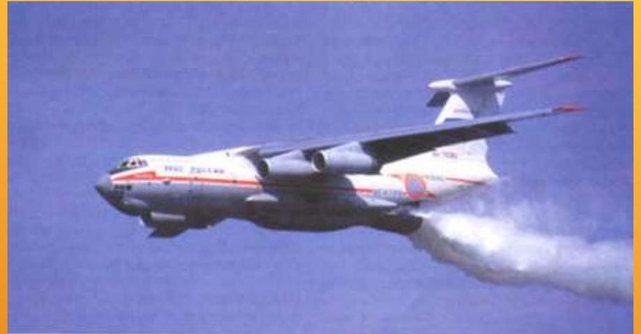
Самолет ИЛ-76 МД со съемным комплексом пожаротушения ВАЛ-2
