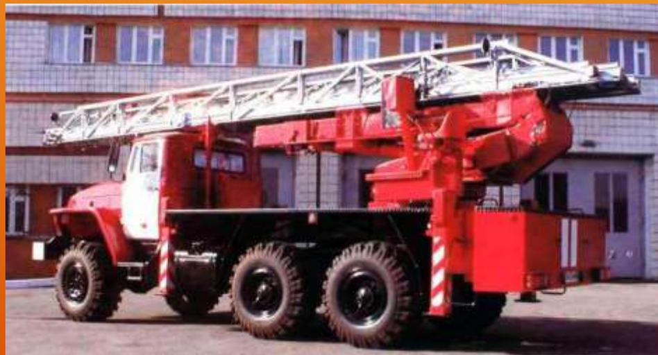
4. ПЕНОПОДЪЁМНИКИ ПОЖАРНЫЕ ПРЕДНАЗНАЧЕНЫ ДЛЯ ДОСТАВКИ К МЕСТУ ПОЖАРА БОЕВОГО РАСЧЁТА, ПОЖАРНО-ТЕХНИЧЕСКОГО ВООРУЖЕНИЯ И ПОДАЧИ ВОЗДУШНО МЕХАНИЧЕСКОЙ ПЕНЫ НА ВЫСОТУ.
